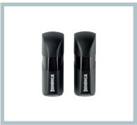
PUPILLA Par de fotocélulas orientables a 180°. Posibilidad de sincronizar hasta 4 pares. Alimentación 24 Vdc. Fácil regulación mediante un LED que indica la alineación correcta. Dimensiones reducidas: 36x110x35 mm.
